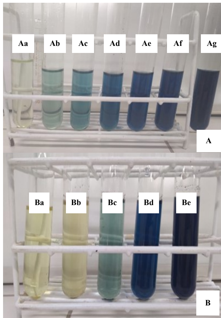
Foto 6. Escalas de patrón y muestra de fósforo (P). A: escala patrón P. Aa: blanco (0 ppm). Ab: 10 ppm. Ac: 20 ppm. Ad: 40 ppm. Ae: 60 ppm. Af: suelo 80 ppm. Ag: >100 ppm. B: contenido de fósforo de distintas muestras. Ba: muestra blanco. Bb: muestra con 4 ppm. Bc: suelo con 25 ppm. Bd: muestra con 63 ppm. Be: muestra 146 ppm.
